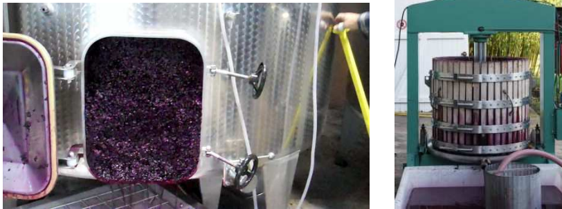
Figure 7 : Marc au bas de la cuve après écoulage. Pressurage avec pressoir vertical.
